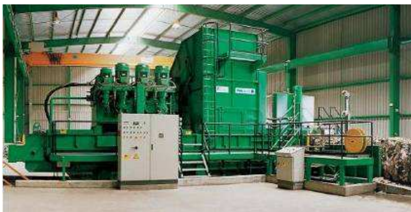
4 pav. Mechaninio atliekų apdorojimo įrenginiai: atliekų būgninis atskirtuvas ir smulkinimo įranga (viršutinis), rankinio rūšiavimo zona (vidurinis), antrinių žaliavų presavimo įranga (apatinis)
