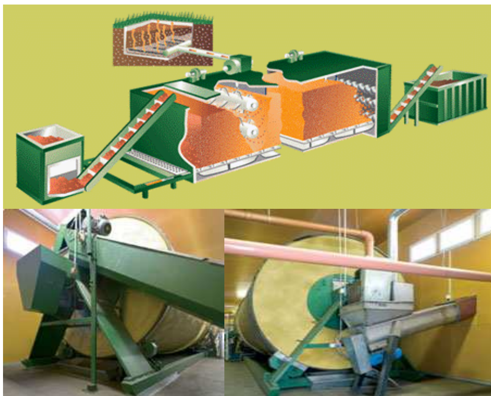
5 pav. Bioskaidžių atliekų kompostavimo įrenginiai: konteineriniai (viršuje), tuneliniai (viduryje), būgniniai (apačioje)
